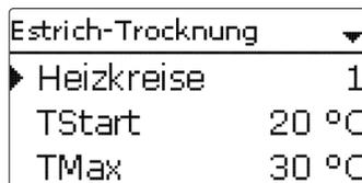
Der Regler springt in das Statusmenü der Estrich-Trocknung. Die aktuelle **Phase** wird im Display angezeigt und die **Restzeit** wird heruntergezählt (dd:hh). Während dieses Vorganges blinkt das Tastenkreuz grün.
