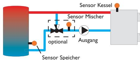
Die Funktion **Festbrennstoffkessel** dient dazu, Wärme aus einem Festbrennstoffkessel an einen Speicher zu übertragen.
