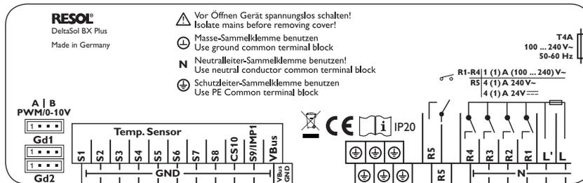
Die mit **PWM/0-10 V** gekennzeichneten Klemmen sind Steuerausgänge für Hoch-effizienzpumpen.
