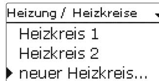
Werden ein oder mehrere externe Erweiterungsmodule angeschlossen, müssen sie im Regler angemeldet werden. Nur angemeldete Module erscheinen bei der Heizkreisauswahl.
