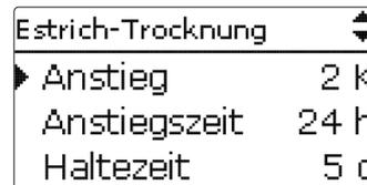
Wird die Vorlaufsolltemperatur nach den ersten 24 Stunden bzw. nach den jeweiligen Anstiegszeiten nicht erreicht oder wird sie dauerhaft überschritten, wird die Estrich-Trocknung abgebrochen.
