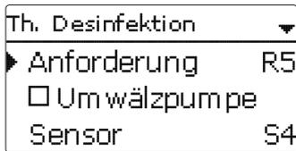
Diese Funktion dient dazu, die Legionellenbildung in Trinkwasserspeichern durch gezielte Aktivierung der Nachheizung einzudämmen.
