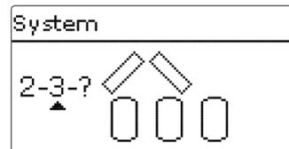
Danach kann die hydraulische Variante gewählt werden. Die jeweilige Variante wird im Display mit Pumpen- und Ventilsymbolen visualisiert. Die beispielhafte Abbildung zeigt das Auswahlbild für System 2.3.2.
