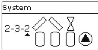
Hier verfügt jedes der Kollektorfelder über ein 2-Wege-Ventil, die Speicher werden über eine Pumpenlogik angesteuert. Für eine Übersicht über die Systeme und ihre Varianten siehe Seite 21.
