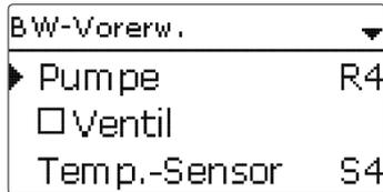
Die **Brauchwasser-Vorwärmung** dient dazu, mit Wärme aus einem Pufferspeicher den Kaltwasserzulauf des Brauchwasserspeichers zu erwärmen.
