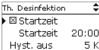
Wenn die **Startzeitverzögerung** aktiviert wird, kann ein Zeitpunkt für die thermische Desinfektion mit Startzeitverzögerung eingestellt werden. Das Einschalten der Nachheizung wird bis zu dieser Uhrzeit hinausgezögert, nachdem das Überwachungsintervall abgelaufen ist.
