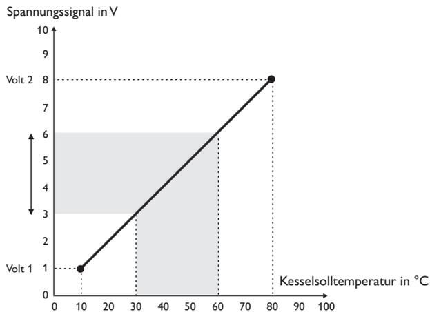
Mit den Einstellkanälen **Tmax** und **Tmin** können die Maximal- und Minimalwerte für die Kesselsolltemperatur eingestellt werden.
