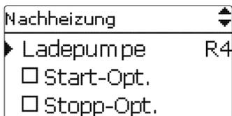
Wird **FSK aus** aktiviert, wird die Nachheizung unterbunden, wenn ein ausgewählter Festbrennstoffkessel aktiv ist.
