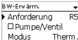
Die **Brauchwassererwärmung** dient dazu, durch Anforderung einer Nachheizung den Brauchwasserspeicher zu erwärmen.
