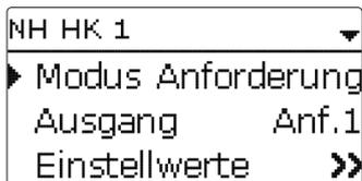
Beim Absenkmodus **Tag/Aus** (siehe Seite 69) werden der Heizkreis und die Nachheizung während des Nachtbetriebs ganz ausgeschaltet. Mit der Option **Start-Optimierung** kann die Nachheizung bereits vor dem Beginn des Tagbetriebs aktiviert werden, damit der Speicher rechtzeitig auf eine ausreichend hohe Temperatur gebracht wird. Mit der Option **Stopp-Optimierung** kann die Nachheizung bereits vor dem Beginn des Nachtbetriebs deaktiviert werden.
