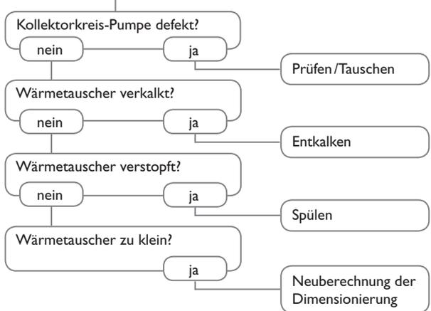
Die Solarkreispumpe läuft nicht, obwohl der Kollektor deutlich wärmer als der Speicher ist.
