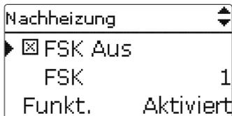
Wird **Solar aus** aktiviert, wird die Nachheizung unterbunden, wenn ein ausgewählter **Speicher solar** beladen wird.
