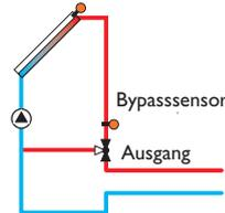
Beispielschemata für die verschiedenen Bypass-Varianten
