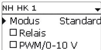
Wenn Anforderung ausgewählt wird, muss zunächst im Menü Heizung / Gem. Relais eine Anforderung aktiviert und eingestellt werden. Wenn Einstellwerte angewählt wird, öffnet sich das Menü Heizung / Gem. Relais / Anforderung.
