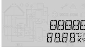
Die Kanalanzeige besteht aus zwei Zeilen. In der oberen 16-Segment-Anzeige werden hauptsächlich Kanalnamen/Menüpunkte eingeblendet. In der unteren 7-Segment-Anzeige werden Werte angezeigt.
