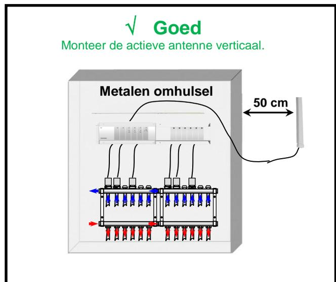
\* Plaats de actieve antenne voor de beste ontvangst op minimaal 0,50 cm afstand van metalen oppervlakken (aansluitkast) en van verticale metalen leidingen.
