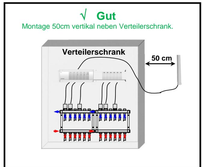
Für eine maximale Empfangsleistung der Antenne sollte diese mit einem Abstand von mindestens 50cm zu metallischen Oberflächen oder vertikalen metallischen Röhren, installiert werden.
