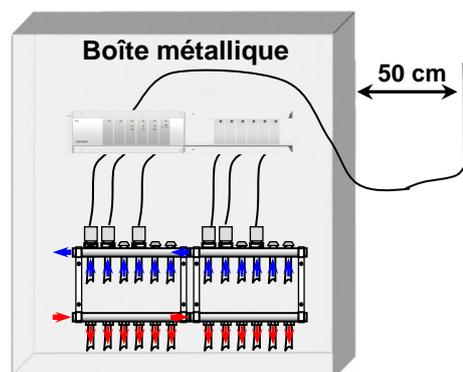
\* Pour une sensibilité radio maximale, l'antenne doit être placée à une distance minimale de 50 cm d'une surface métallique (boîte métallique) ou des tuyaux métalliques verticaux.
