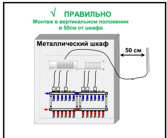
\*\* Для достижения максимального качества приема и при работе в тяжелых условиях антенна должна быть установлена в вертикальном положении на расстоянии минимум в 50см от металлической поверхности (защитный шкаф) или металлических трубопроводов.
