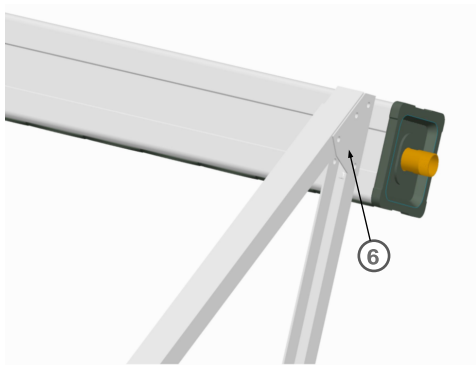
3. Gebruik de driehoeks verbindingstukken ( nr. 6 ) om het collector frame aan de drie achter staanders te monteren
